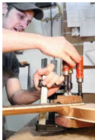
Instalando los trastes. En las acústicas se usa un calibre pequeño.
