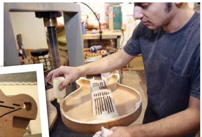
Una I-35 con el cajado final lista para encolarle su tapa de arce (derecha).
